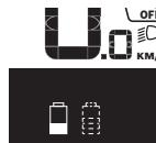
Ha az eBike-ba két akku van behelyezve, és mindenkorban a kerékpáron tölti, akkor a kijelző mindenkorban töltésének előrehaladása megjelenik (az ábrán éppen a bal oldali akku töltése folyik). Az akku villogó jelzéséről megismerheti, hogy a két akkumulátor közül melyik akkumulátor töltése folyik éppen.
