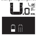
Če se na električnem kolesu z dvema akumulatorskima baterijama polnila obe akumulatorski bateriji, je na prikazovalniku naveden napredok polnjenja obeh akumulatorskih baterij (na sliki se polni leva akumulatorska baterija). Po utripragočem prikazu na akumulatorski bateriji lahko vidite, katera od obeh akumulatorskih baterij se trenutno polni.
